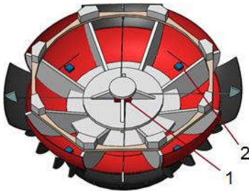
1-Động cơ điều khiển cánh tà, 2-Động cơ điều khiển cánh xoay
