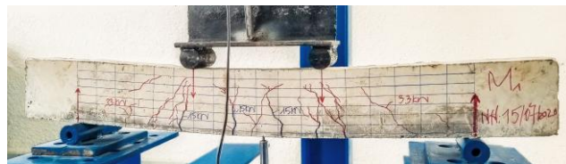
Hình 7: Thí nghiệm phá hoại dầm M1
