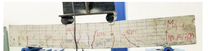
Hình 13: Thí nghiệm phá hoại dầm M4
