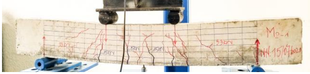
Hình 9: Thí nghiệm phá hoại dầm M2
